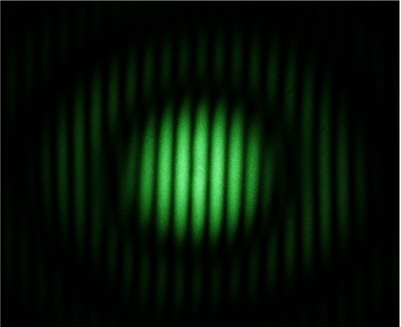
Figure de diffraction-interférences de fentes d'YOUNG éclairés par divers LASER
