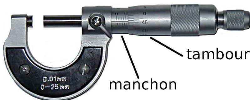
FIGURE 4 – Vis micrométrique
