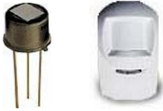
Figure 5- Les détecteurs pyroélectriques sont utilisés par exemple dans les systèmes infrarouges passifs de détection d'intrusion.
