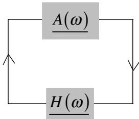
Le critère de BARKHAUSEN correspond à la limite entre la divergence et la convergence des oscillations c'est à dire lorsque que le signal complexe est multiplié exactement par l'unité lors du parcours de la boucle, soit un gain de boucle :
