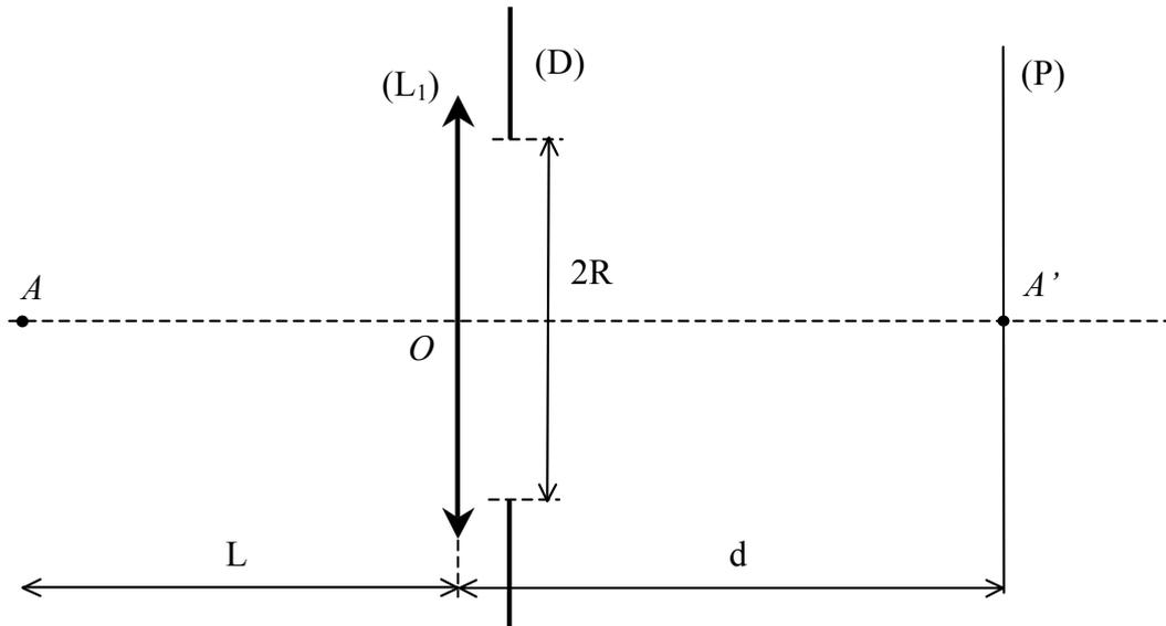
On assimile l'objectif d'un appareil photographique à une lentille mince convergente ( $L_1$ ) de centre  $O$  et de distance focale image  $f'_1 = 50,0$  mm. La pellicule sensible se trouve dans un plan (P) perpendiculaire à l'axe optique, à une distance  $d$  de l'objectif que l'on peut faire varier (mise au point).
