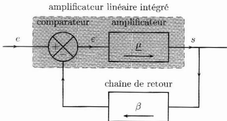
FIG. 7.2.1. Système bouclé.
