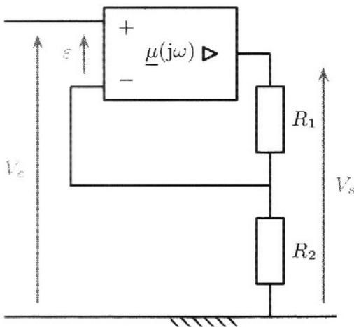
FIG. 7.3.1. Amplificateur non inverseur.
