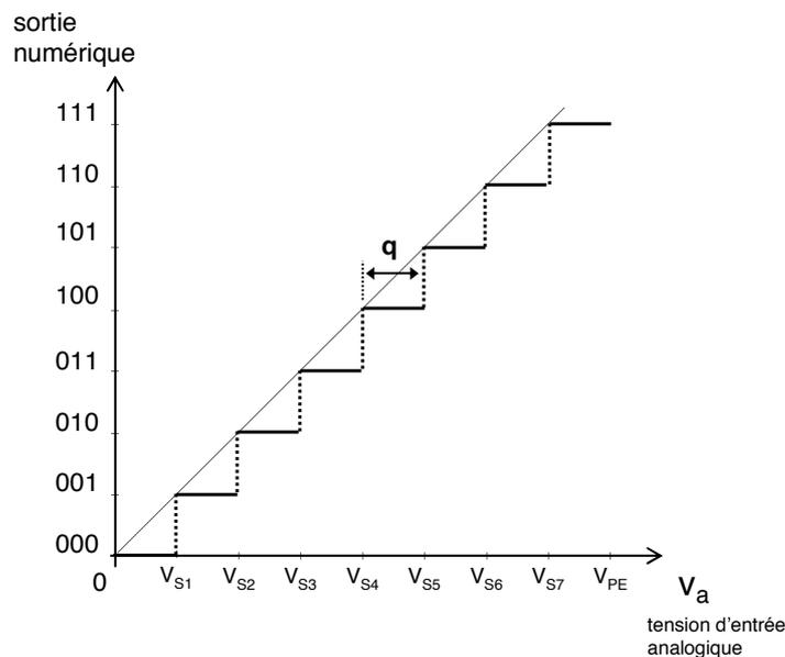
Fig. II.6 – Caractéristique de transfert idéale d'un CAN à quantification linéaire par défaut.
