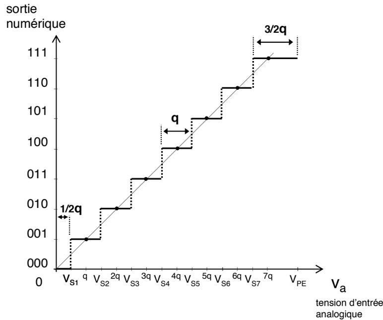
Fig. II.8 – Caractéristique de transfert d'un CAN à quantification linéaire centrée.
