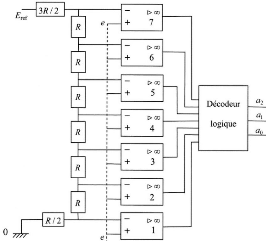
Une tension analogique  $e$  pouvant varier de 0 à 7V est convertie en signal numérique sur 3 bits  $a_2a_1a_0$ . Pour cela, on réalise le CAN parallèle (ou flash) 3 bits représenté ci-dessous. 7 ALI supposés idéaux sont placés en parallèle. La tension d'entrée  $e$  est envoyée sur les bornes  $V^+$  des 7 ALI. Un réseau de résistances montées en série est alimenté par une tension de référence  $E_{\text{ref}} = 8\text{V}$ .
