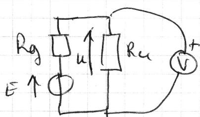
donc si on mesure  $3V = \frac{E}{2} \Rightarrow Rg = R_u = 50\Omega$
