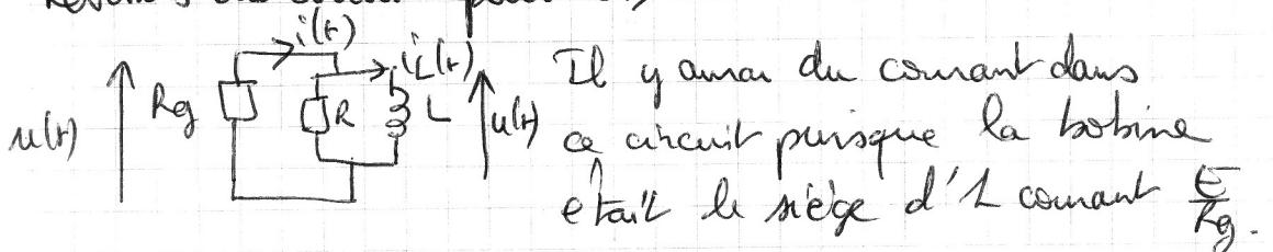
Il y aura du courant dans ce circuit puisque la bobine était le siège d'un courant  $\frac{E}{Rg}$ .
