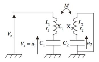
Réaliser ce montage avec nos deux bobines quasi-identiques précédentes accolées associées à deux condensateurs de même capacité  $C_1=C_2=C=10$ nF (boite à décade de capacités)
