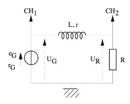
La bobine à étudier est placée en série avec un résistor de résistance connue  $R=100\,\Omega$  aux bornes d'un générateur de fonction délivrant une tension sinusoïdale de fréquence f.
