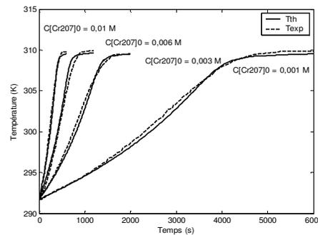
Figure 3-2 Comparaison du modèle proposé avec l'expérience : identification globale
