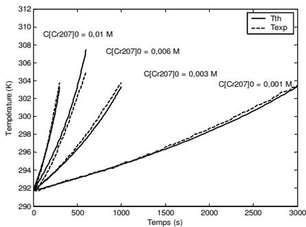
Figure 3-1 : Comparaison du modèle proposé avec l'expérience : identification sur le début des courbes
